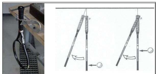
Figure 6. Le centre de percussion P est un point important de la géométrie de la raquette qu'il faut savoir prévoir avant la fabrication.
