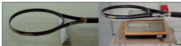
Figure 7. Le centre de gravité et le poids de la raquette doivent être caractérisés avec précision.
