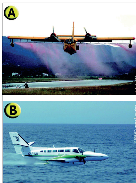
Figure 7. (A) Épandage aérien dispersant au Canadair. Essai de calibration au sol de l'épandage. (B) Le Cessna équipé du POD en train d'épandre le dispersant. Source : [A] Cedre/IFP, 1980, Cuers ; [B] SAM/Douanes Françaises, 25-27 mai 2004.
