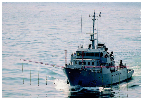
Figure 8. Des navires de la Marine nationale sont équipés pour épandre des produits dispersants. Source : Marine nationale, 2004.
