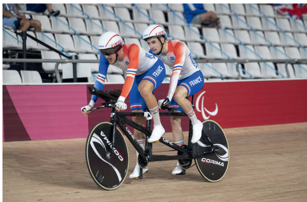
Vélo tandem de para athlètes de l'équipe de France en fibre de carbone. (D.R.)
