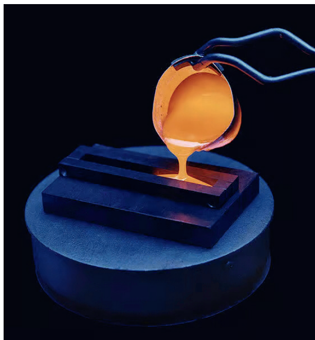
Procédé de vitrification des déchets pour l'industrie nucléaire © CEA
