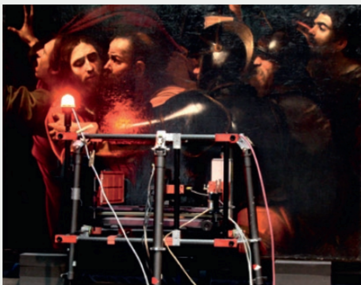
Analyse par diffraction des rayons X et fluorescence des rayons X d'un tableau du Caravage, L'arrestation du Christ , Galerie nationale d'Irlande, Dublin.
