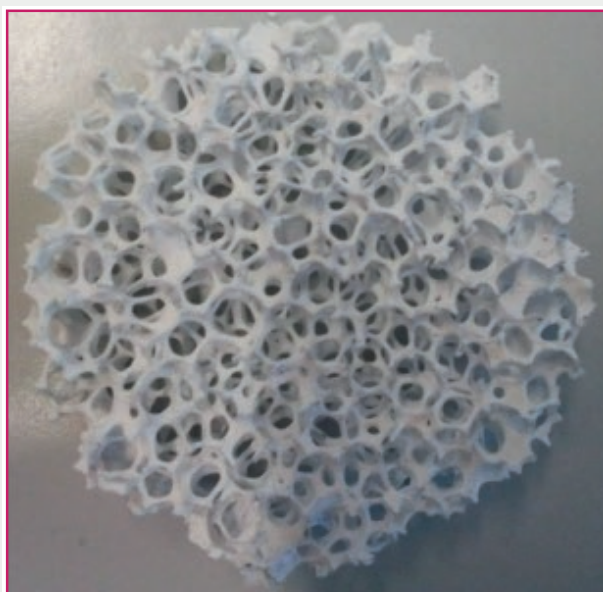
Média photocatalytique constitué d'une mousse alvéolaire structurée recouverte d'un dépôt de nanoparticules de \text{TiO}_2 .
